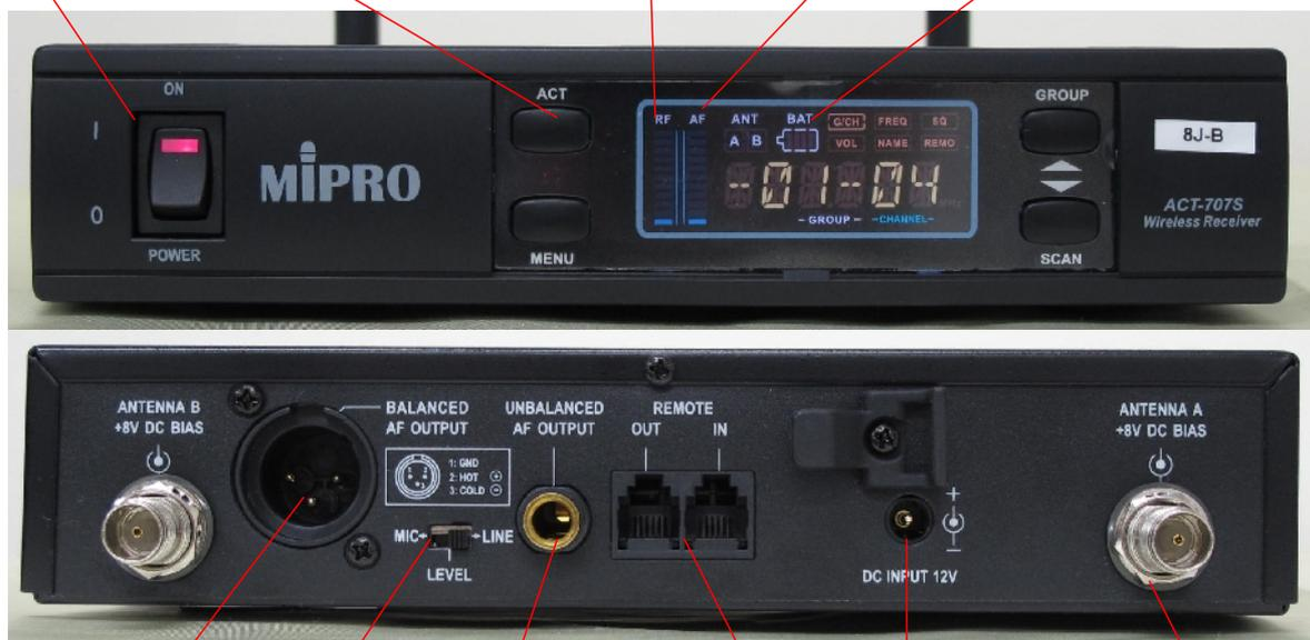
XLR音声出力 出力レベル切り替えスイッチ 6.3mm音声出力 電源コネクター TNCアンテナコネクター (別売)リモートコントロールソフト用コネクター
