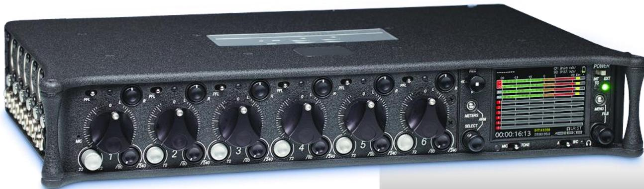
**664 ミキサー**は、評価の高かった 552 ミキサーをさらに昇華させたサウンドデバイス社のポータブルオーディオミキサーです。6つの XLR マイク/ライン入力と4つのミキシングバス出力を持ちます。Ch1~Ch6のダイレクト出力 TA-3 コネクターは、Setup メニュー画面からの設定により、Ch7~Ch12のライン入力として利用することができます。全12チャンネル入力と4バス出力は、内蔵の 16Tracks デジタルレコーダーで、CF と SD カードに録音することができます。
