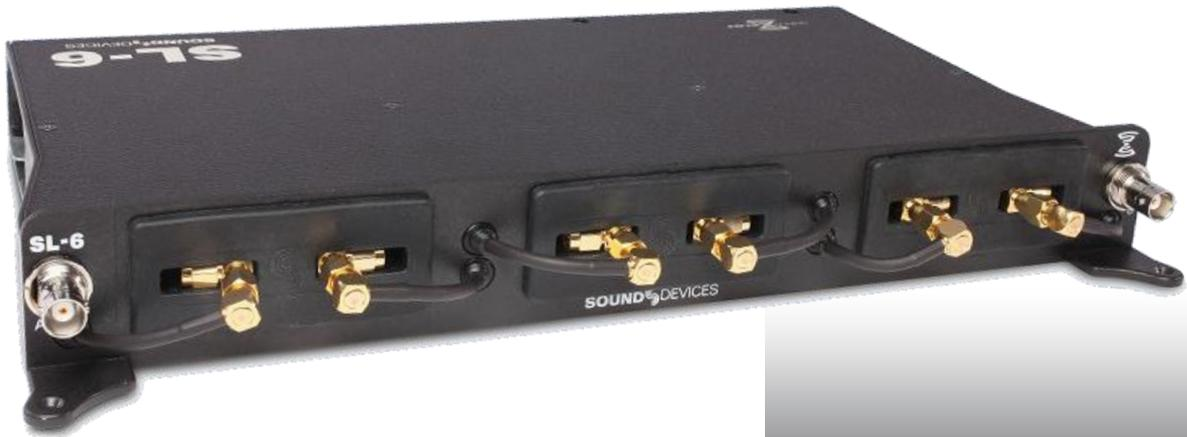
Sound Devices 688 ミキサー専用オプションの SL-6 は、デュアルチャンネル・ワイヤレスレーザー用のスロットを3つ備えます。SL-6 により、688 ミキサーとレーザーユニット間の電源やオーディオケーブルの接続が単純化されます。SuperSlot™対応のレーザーを装着すると、電源とオーディオの接続だけでなく、688 の画面からレーザーをコントロールすることができます。SL-6 の左側面のバッテリースロットに NP-1 バッテリーを装着して、スロットレーザー、688 ミキサーに給電できるだけでなく、外部周辺機器用にサービス・ポートのコアキシャル DC 出力を利用することができます。SL-6 は内蔵アンテナ分配システムを持つだけでなく、外部アンテナ用のプースターアンプに 12V のバイアス電圧を供給することができます。
