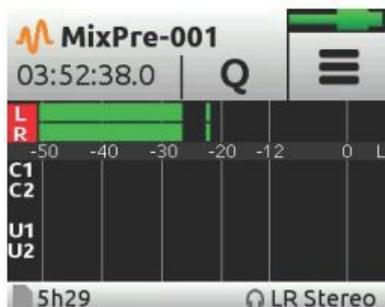
3つのメインメーター・ビューを切替えるのは簡単です。メーターをタッチするだけで、異なるビューが順に切り替わります。メーターは信号レベルだけでなく、レコーダー用の各トラックのアームステータス、L、R と各チャンネルのリミッター動作状況も表示されます。
