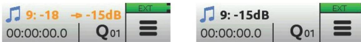
この例では、フィジカルフェーダーの値が -18dB で、トラック 9 のチャンネル・ノブを時計回転方向に調整しなければならないことを矢印が示します。以前にストアされている値、ここでは -15dB に達すると、ミックスレベル調整できるようになります。
