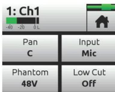
ここでは、チャンネルのインプット・ソースの選択、ミックスバスとステレオ出力への Left, Center, Right へ送る設定、ファンタム電源（コンデンサー・マイクロフォンとアクティブ DI 用）の設定、ローカット・フィルターの設定 があります。MixPre-3 の Kashmir™ マイクプリアンプは非常に広いダイナミックレンジ、ローノイズなオーディオ特性に加えてアナログ・リミッター機能が基本的に備わっているので、LR ミックス録音チャンネルとステレオ出力に送るためにチャンネル・ノブを調整してレベル調整する以外には細かな調整を必要としません。
