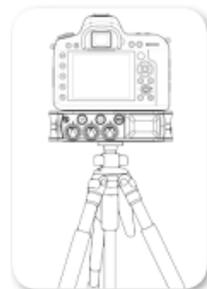
3. もしカメラに回転防止ピンがある場合は、MixPre-3 の天板の穴に(背面パネルから取り外した)回転防止ピンを装着し、カメラの底面に対して MixPre-3 の位置を決めてカメラの固定用穴にピンが収まるように調整します。
