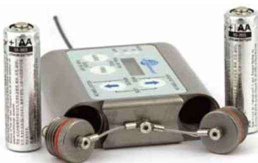
バッテリー収納部は Oリングで密閉されます。
