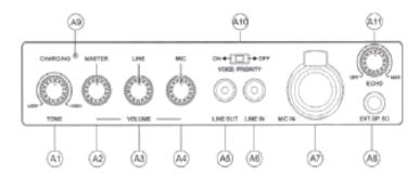
① TONE:時計 12 時が中点で、左(低音増加)右(高音増加)調整できます。
