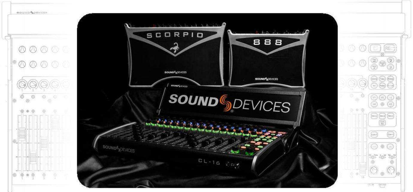
CL-16 は、8-Series デジタルミキサー・レコーダー(SCORPIO, 888, 833) 用のコントロール・サーフェースです。8-Series の DSP ミキシングがフィジカル・コントローラにリアルタイムに反映されるので、アナログミキサーの操作性を提供します。同時に、デジタルミキサーの柔軟性も兼ね備えた CL-16 は、フィールドコーディングに求められるさまざまな要望にも応えます。
