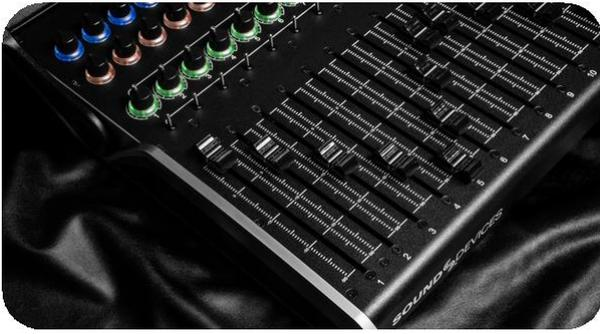
フェーダー部品には、Penny&Giles 製の非モーター駆動、高品質スライダフェーダーが採用されました。同社は 1956 年に設立され、長年に渡り信頼性の高いパーツを供給してきました。Sound Devices の CL-12 Alaia にも P&G フェーダーが採用されており、その信頼性は実証済みです。CL-16 設計時に他社の部品も検討しましたが、良好な操作フィーリングの P&G フェーダーが再び採用されました。
