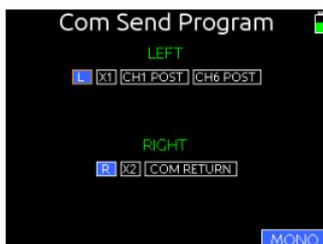
3. HP エンコーダを回して、ソースオプション上のオレンジ色のカーソルを移動させます。COM Send の左チャンネル用と右チャンネル用で、設定できる内容は異なります。
