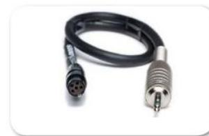
*Info: MixPre-D の Tape Out 3.5mm TRS は次のピン配です。 Tip=左 ch, ring=右 ch, sleeve=ground。*
