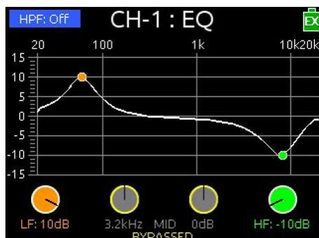
複数のインプットに関して EQ を同時に調整することはできません。複数チャンネルの SEL が選択されている時、EQ の調整は、最後にグループに追加されたチャンネルにだけ反映されます。
