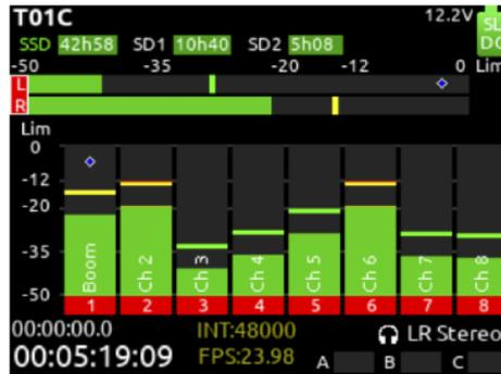
ノイズサプレッションを効果的に使用するには、デフォルト設定の-6dB から始めて、環境に応じて適用レベルを調整してください。音を着色せずにバックグラウンドノイズが低減される量が理想的です。
