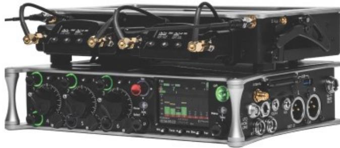
SL-2（上記 833 に装着）は、2 つのスロットイン式ワイヤレス受信機統合システムで、8 シリーズミキサーレコーダーのトップパネルに簡単に取り付けられます。様々なメーカーの UniSlot および SuperSlot™ ワイヤレス受信機に対応しています。SL-2 と受信機への電源は 8 シリーズミキサーレコーダーから供給されるため、SL-2 に外部 DC コネクタは不要です。アナログまたはデジタルオーディオは、受信機から拡張ポートを介してミキサーレコーダーに送信されるので、電源とオーディオ接続のための煩雑な配線が軽減されます。
