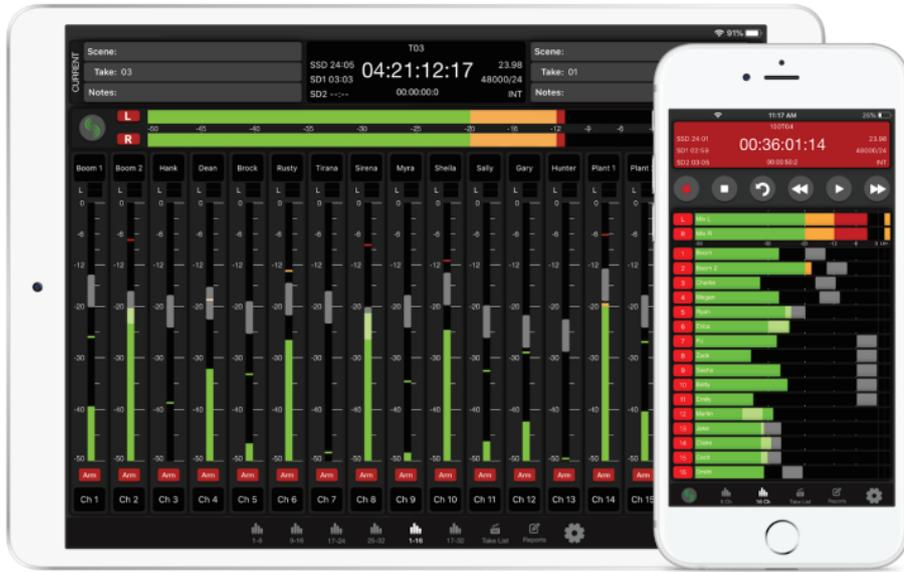
SD-Remote は、888 とペアリングするように設計されたモバイル デバイス アプリケーションです。SD-Remote は、Android タブレットおよび携帯電話では Google Play ストアで、または APK として [www.sounddevices.com](http://www.sounddevices.com) から、iPhone および iPad では App Store で入手できます。Android タブレットは、USB 経由で 888 にハードワイヤード接続するか、Bluetooth LE 経由でワイヤレス接続することができます。Android フォン、iPhone、または iPad は、Bluetooth LE を介してワイヤレスで 888 に接続します。SD-Remote は、以下を含む制御および表示パラメーターを提供します。
