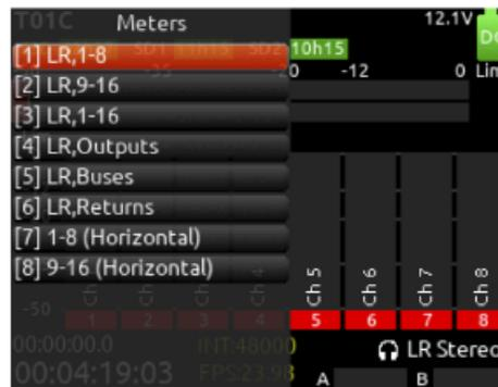
注：LR 出力および LR バスメータービューでは、セレクトノブを回すと出力またはバスまでスクロールできます。セレクトノブを押すと、その出力またはバスルーティング画面へのショートカットとして機能します。
