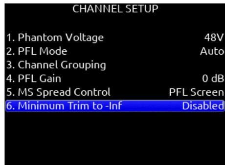
**1. PHANTOM VOLTAGE** 全入力ファンタムパワー電圧の設定。 [12V, 48V]
