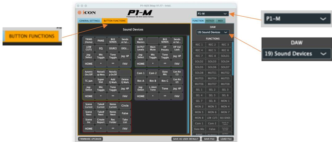
P1-M のタッチディスプレイのレイアウトはカスタマイズ可能です。Sound Devices は、利便性向上のため、カスタムプリセットの iMAP 設定と 8 シリーズコントローラーのマッピングファイルを用意しました。これらを組み合わせることで、よく使う機能をこのタッチディスプレイにマッピングできます。
