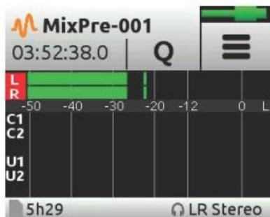
3つのメインメーター・ビューを切替えるのは簡単です。 メーターをタッチするだけで、異なるビューが順に切り替わります。 メーターは信号レベルだけでなく、レコーダー用の各トラックのアームステータス、L, R と各チャンネルのリミッター動作状況も表示されます。
