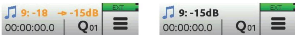
この例では、フィジカルフェーダーの値が -18dB で、トラック 9 のチャンネル・ノブを時計回転方向に調整しなければならないことを矢印が示します。以前にストアされている値、ここでは -15dB に達すると、ミックスレベル調整できるようになります。
