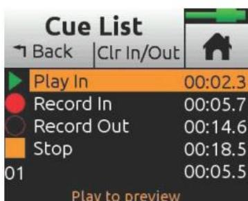
1 曲につき最大 20 個のキューポイントを作ることができます。キューに名前を付ける、移動、削除、あるいは Q-List から Play In, Record In/Out, Stop ポイントとして設定することができます。
