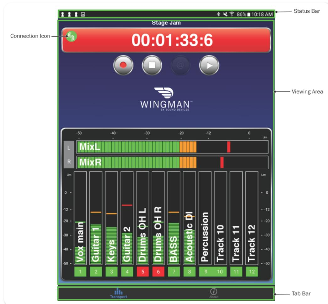
Wingman のタッチ画面インターフェースは、3つのメインエリアで簡単操作とモニタリングを提供します。
