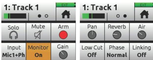
(B) Input をタップし、HP エンコーダーを回してインプット・ソースを選択します。
