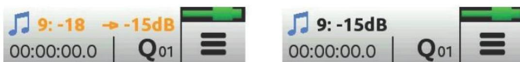
*Info:* 以前にストアされたフェーダー値と矢印アイコン（オレンジ色）を表示させるためには、チャンネル・ノブをごくわずか調整してください。情報が表示されることで、どちらの向きへフェーダーを調整するべきかを判断できます。
