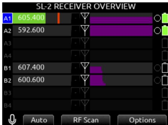
**POST-TRIM CHANNEL METERING** SL-2 ソースからのオーディオ信号は、Scorpio チャンネルのトリムで調整後の信号レベルを見ることができます。SL-2 ソースが Scorpio チャンネルにルーティングされていない場合、メーターに信号は表示されません。
