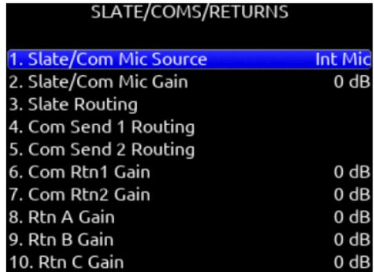
**Slate/Com Mic Gain** 1 dB ステップ調整で slate/com マイク用のゲイン設定。 [-10~20dB (Internal mic) ] [0~60dB (external mic)] 1dB ステップ調整。
