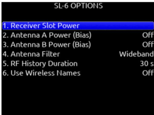
**RECEIVER SLOT POWER** 使用しないレシーバーは、バッテリー消費を抑えるために、個々にオフにすることができます。レシーバーのユーザーインターフェースからのレシーバーの電源のオン/オフはサポートされていません。
