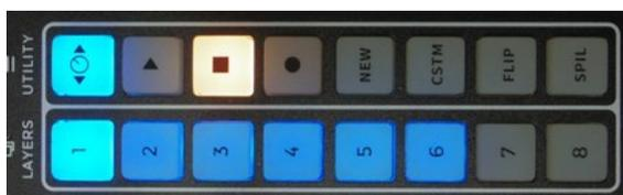
モードを切り替えるには、UTILITY ボタンを押してから、LAYERS の数字ボタンを押してください。モード設定後に UTILITY ボタンを押しても、選択されたモードのままにコントローラを操作できます。
