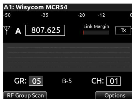
SL-2 の A1 スロットを GR:05, CH:01 をアサインしてから RF Group Scan を実行すれば B 帯の GP:05 にプリセットされた周波数の中から電波状況の良いものがリストの一番上に表示されます。
