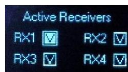
MCR54 本体のボタン操作から Active Receivers 画面のチェックマークを外すと節電できます。(8-Series を再起動してもこの設定は保持されます。)
