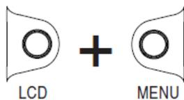
フォーカス・アシストは、狙った対象物にフォーカス（焦点）を合わせるのを補助するために、ビデオ映像にシャープエッジなマーキングを表示する機能です。フォーカス・アシストを有効にするには、LCD ボタンと MENU ボタンを同時に押してください。フォーカス・アシストが有効になると、OSD ディスプレイに”FOCUS”と黄文字で表示されます。フォーカス・アシストは、ピーキングとエッジ・エンハンスの2種類があります。
