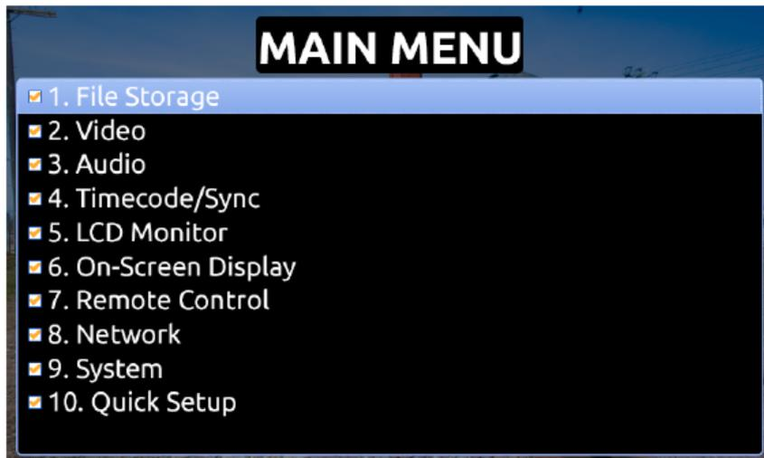
6. Setup Menu のアイテムの表示 / 非表示を変更するには、アイテムがハイライト状態でキーボードのスペースキーを押してください。チェックマークがあると Setup Menu のリストに表示され、チェックマークが無いとリストに表示されなくなります。
