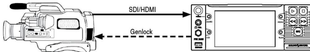
この場合、PIXはビデオシンクのマスターソースです。選択されたレートへシンクジェネレータの出力を設定し、PIXのシンク出力(ゲンロック)を同じカメラに接続してください。PIXのタイムコード出力をカメラのタイムコード入力に与えてください。
