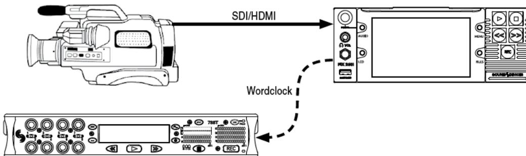
PIX のワードクロック出力は入力される映像信号に同期します。外部オーディオレコーダーは PIX を介してカメラと同期することができます。ワードクロック出力を有効にするには、Setup メニュー：**Timecode/Sync Sync Out** を **Wordclock, Follows Video In** に設定してください。
