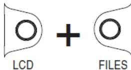
エクスポージャー・アシストは露出レベルを感知してビデオイメージに領域を表示する機能です。露出尾オーバーか露出アンダーの領域ははっきりと示し、レコーダーが正しい露出の映像信号になるようにカメラ側を調整できるようにします。エクスポージャー・アシストを有効にするには LCD ボタンと FILES ボタンを同時に押してください。エクスポージャー機能が有効になると、画面の OSD 表示項目に黄文字で“EXP”が表示されます。
