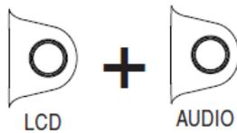
ズーム機能は、画像を 1:1 ピクセル比のビデオイメージに拡大するピクセル等倍表示機能です。LCD ボタンと AUDIO ボタンを同時に押すと、ズーム機能のオン/オフが切り替えられます。ズーム機能が有効なとき、OSD ディスプレイには黄文字で”ZOOM”と表示され、他の OSD 要素はすべて非表示となります。ズーム領域は、ロータリーエンコーダーで上下移動、REW/FF キーで左右移動することができます。
