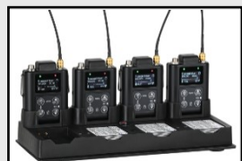
LBC61/LBC61_XL マルチプルチャージャー MTP61/MPT61 XL を 4 台、 LBP61/LBP61XL を 4 枚同時充電 録音データ転送やタイムコードの 同期、PC 接続用 RJ45 を搭載
