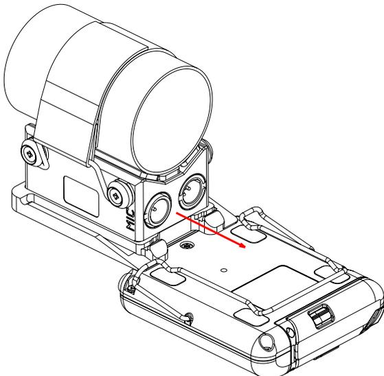
3. 図のようにMTP60をクリップで固定して取り付けます。
