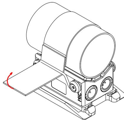
2. ポールにフェルトを通し、もう一方の端を固定します
